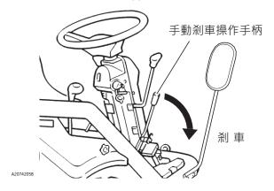
手動剎車操作手柄往箭頭所示方向 操作時,機體會停止移動。
