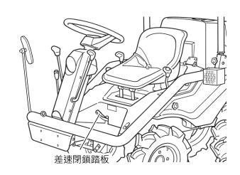
踏下差速閉鎖時,左右側的前輪會同時驅動(閉鎖狀態,放開時即可解除。
